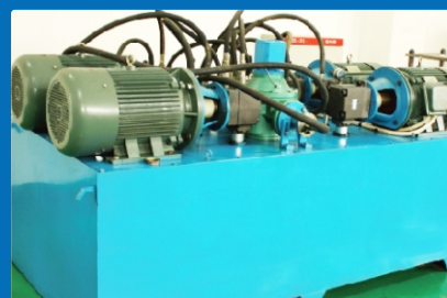
高精度压力损失试验台
