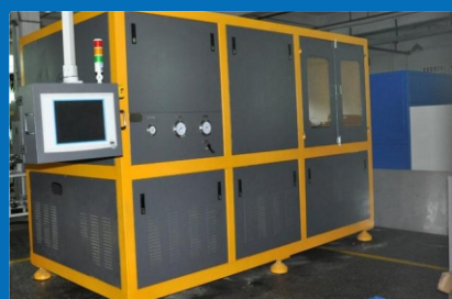
接头循环耐久性试验台
